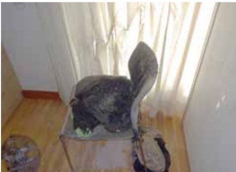
奏功事例② 焼損した椅子とカーテン。防災カーテンは一部溶融しているのみで延焼していない。
